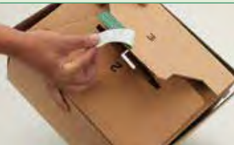
Bodenlaschen nach innen, Verschlusslaschen mit progress-Selbstklebeverschluss verkleben
